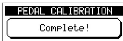
“Complete!” と表示され、ペダルのキャリブレーションが完了します。
