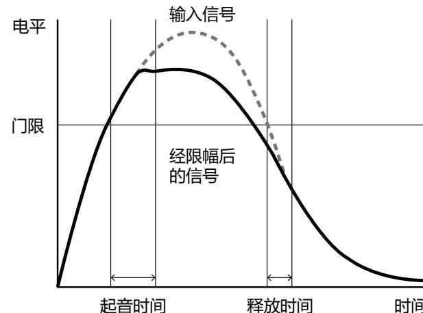
当限幅器设置为 ON 时，如果输入信号的电平超过所设置的门限数值，为了防止音色产生失真，信号电平将被抑制。
