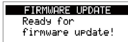
2. Starten Sie das Programm zur Aktualisierung der Firmware auf dem Computer. Die Aktualisierung wird gestartet. Zum Abschluss der Aktualisierung wird „Complete!“ eingeblendet.
