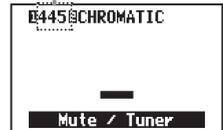
Der Kammerton kann auf eine Frequenz zwischen 435 und 445 Hz eingestellt werden. (Voreinstellung: 440 Hz)
