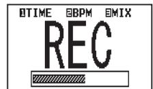
Im Display wird „REC“ angezeigt und das Overdubbing wird gestartet.
