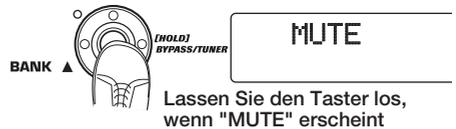
Nachdem „BYPASS“ oder „MUTE“ angezeigt wurde, schaltet das Display automatisch zur Tuner-Darstellung.
