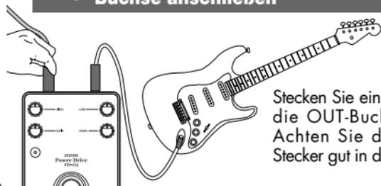
Stecken Sie ein anderes Kabel in die OUT-Buchse des PD-01. Achten Sie darauf, daß der Stecker gut in der Buchse sitzt.
