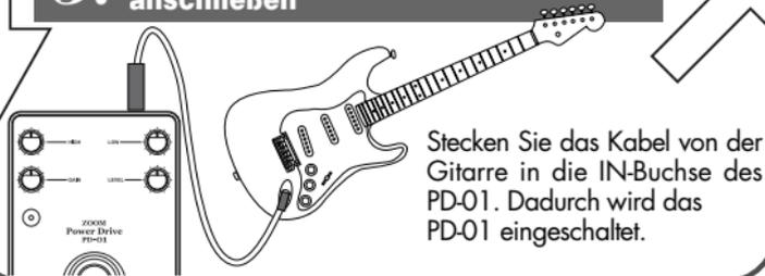
Stecken Sie das Kabel von der Gitarre in die IN-Buchse des PD-01. Dadurch wird das PD-01 eingeschaltet.
