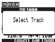
Die Anzeigen von verfügbaren Tracks blinken orange. Wählen Sie einen Track über seine Statustaste aus.
