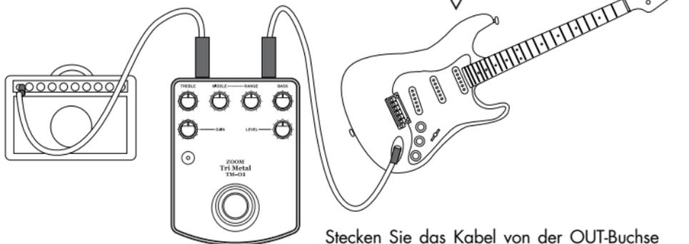
Stecken Sie das Kabel von der OUT-Buchse des TM-01 in die IN-Buchse des Verstärkers.
