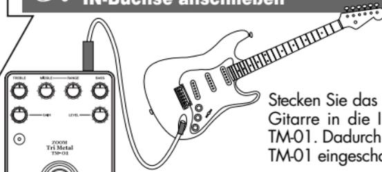
Stecken Sie das Kabel von der Gitarre in die IN-Buchse des TM-01. Dadurch wird das TM-01 eingeschaltet.
