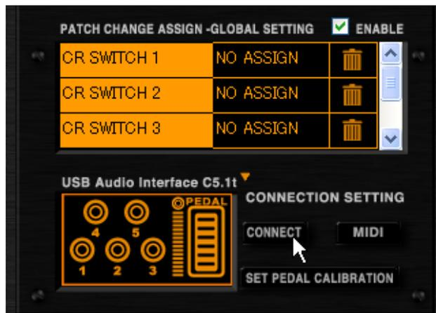
Die [CONNECT]-Taste leuchtet auf und das zugehörige Plug-In empfängt nun die Pedal-/Schalt-Events.
