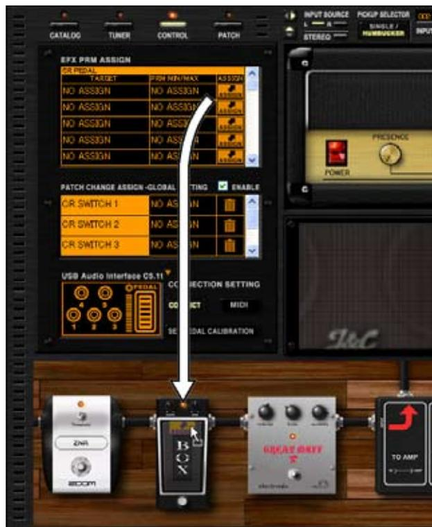
Nun wird der "WAH"-Parameter der "PEDAL BOX" dem Expression-Pedal zugeordnet.
