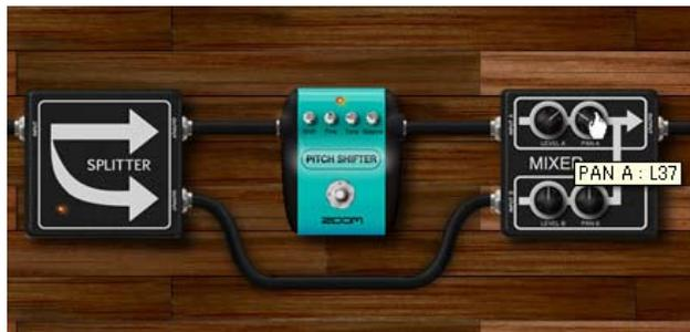
Das Panning von Kanal A wird eingestellt. Im Uhrzeigersinn positionieren Sie das Signal auf der rechten Seite, gegen den Uhrzeigersinn auf der linken. Für das Panning von Kanal B stellen Sie den Regler [PAN B] ein.
