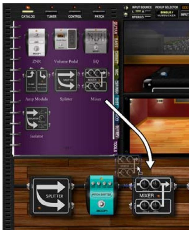
Der Mixer wird eingefügt. Wie oben dargestellt verfügt der Mixer über die beiden Eingangsbuchsen [INPUT A] und [INPUT B]. Über diese Buchsen lassen sich zwei Signale zu einem Signal zusammenmischen.
