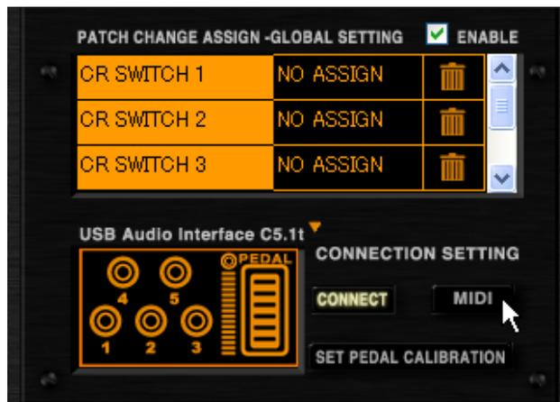
Die [MIDI]-Taste leuchtet auf und das ZFX-Plug-In empfängt nun die MIDI-Befehle. Für eine Automation oder andere Steueranwendungen sollte die [MIDI]-Taste immer aktiv sein.
