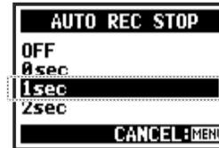
Réglez la temporisation (1-5 secondes) avant l'arrêt de l'enregistrement une fois le niveau redescendu sous le seuil d'arrêt (STOP LVL).
