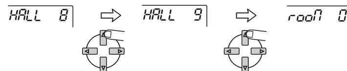
Premendo i tasti left/right [PARAMETER/VALUE] si passa direttamente all'algoritmo successivo.
