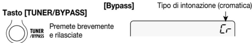
Quando tenete premuto il tasto [TUNER/BYPASS] per un secondo o più, PFX-9003 entra nella condizione di mute (suono diretto ed effetti disattivati). L'indicazione "CHRMTC" viene brevemente mostrata sul display, e quindi viene mostrata una "M" (per Mute). Il tuner cromatico può ora essere usato.
