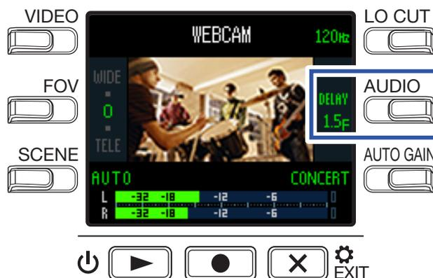
Premete ancora **DELAY** ripetutamente per allungare il tempo di delay audio.
