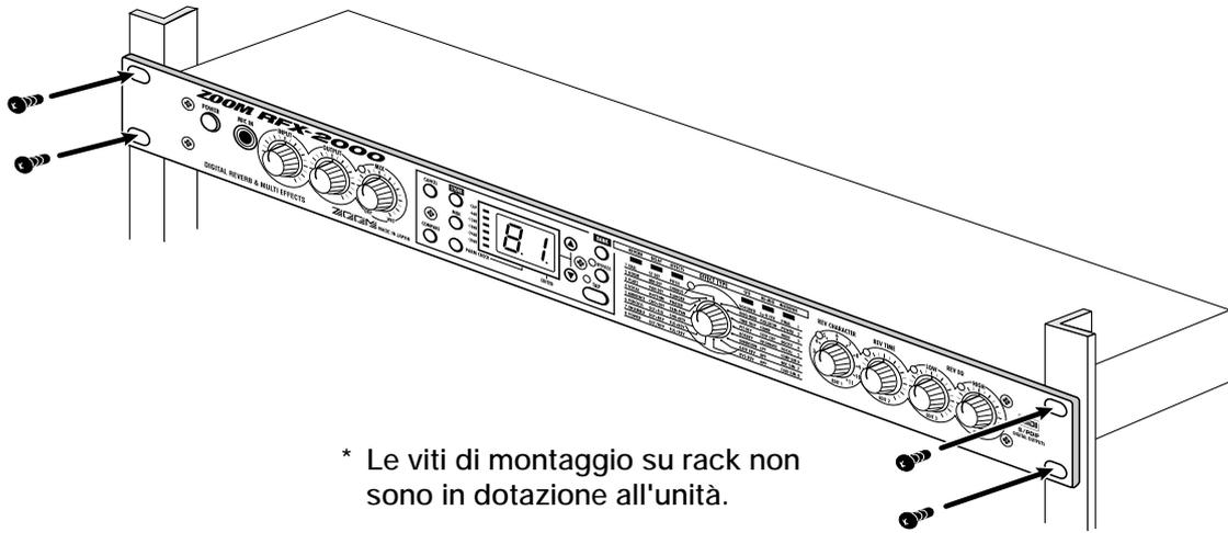
\* Le viti di montaggio su rack non sono in dotazione all'unità.
