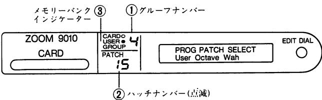
パッチナンバーが点滅し、そのナンバーが選択されているが読み出されていない状態であることを示します。
