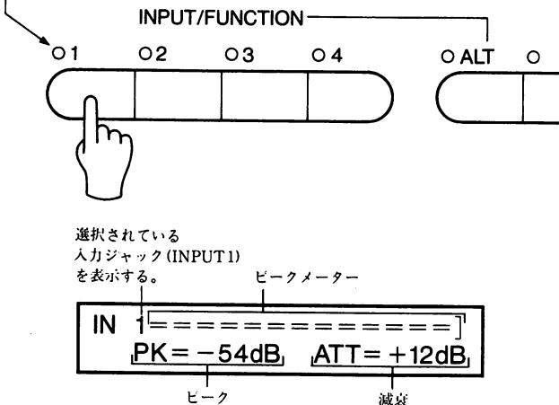
選択されている入力ジャック (INPUT 1) を表示する。減衰ピーク ピークメータ
