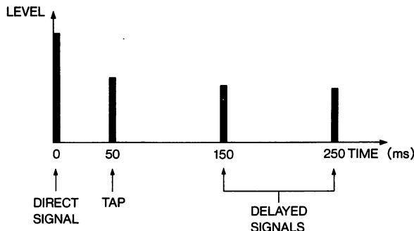
タップパラメーターは最初のディレー時間を決め、ディレーパラメーターはタップのディレーリピートの間隔を決めます。
