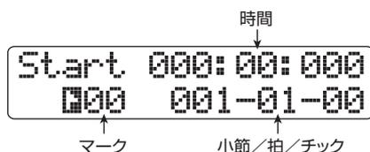
11. 左右のカーソルキーを使って点滅部分を移動させ、ダイヤルを回してデュオハーモニーの開始位置を指定してください。
