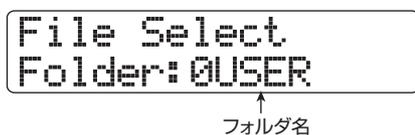
4. ダイアルを回して、目的のサンプルを含むフォルダを選び、[ENTER]キーを押してください。
