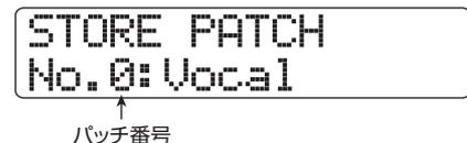
**2.** ディスプレイ1行目に“STORE PATCH”（保存）または“SWAP PATCH”（入れ替え）と表示されていることを確認し、[ENTER]キーを押してください。**3.** ダイヤルを回してディスプレイ2行目に保存／入れ替え先のパッチを表示させ、[ENTER] キーを押してください。
