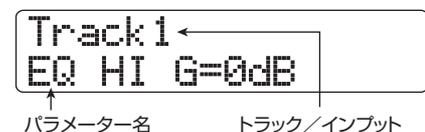
2. 左右のカーソルキーを使って、操作したいトラック/インプットを選択してください。
