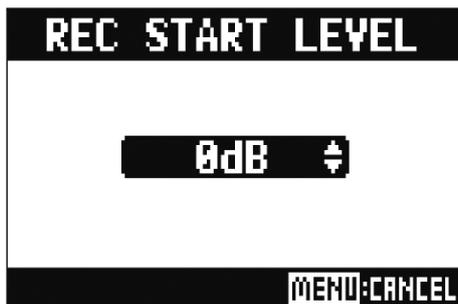
MASTER フェーダー通過後の信号が設定したレベルを上回ったときに、自動的に録音を開始します。
