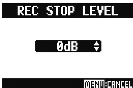
MASTER フェーダー通過後の信号が設定したレベルを下回り、手順 2 で設定した時間が経過したときに自動的に録音を終了します。
