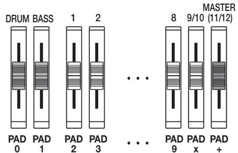
あるフェーダーを動かすと、瞬時に対応するパッドが操作の対象として選ばれ、そのレベルが変化します。必要ならば、[BANK/OCTAVE] キーを使って、パッドバンク (1 または 2) を切り替えることも可能です。
