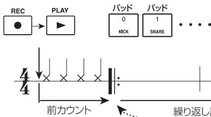
記録中にREC[●]キーを押すと、REC[●]キーが点滅に変わり、記録が一時的に解除されます。この間、パッドを叩いてリハーサルを行ったり、パッドに割り当てられている音色を確認したりできます。もう一度REC[●]キーを押すと、記録状態に戻ります。
