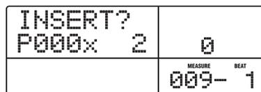
[ENTER]キーを押すと、9小節目の先頭に新しいリズムパターンが挿入され、“EOS”の表示が11小節目の先頭に移動します。
