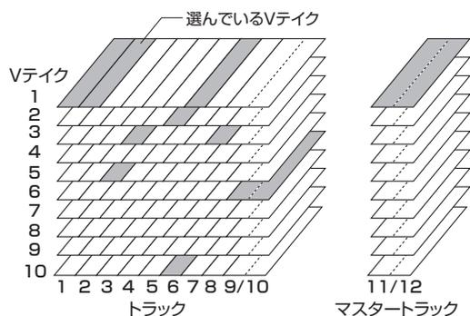
また、レコーダーセクションには、最終的なステレオミックスを記録するために、通常のトラック1～10からは独立したステレオ仕様のトラックが搭載されています（これを“マスタートラック”と呼びます）。マスタートラックは、ミックスダウン専用のトラックとして、あるいはオーディオCDを制作するときの素材として利用できます。
