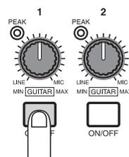
ステレオソースの楽器を接続した場合は、2つの端子の [ON/OFF] キーを同時に押して、キーを点灯させてください。通常は同時に2つまで有効にできます（3つ目の [ON/OFF] キーをオンにすると、最初にオンにしたキーが無効となります）。
