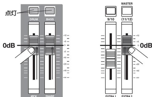
リズムセクションのドラム音色とベース音色は、それぞれ内蔵ミキサーの該当するフェーダーに送られています。[DRUM] / [BASS] のステータスキーで音色のオン / オフ切り替え、[DRUM] / [BASS] のフェーダーで音量を調節できます。
