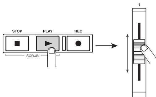
必要ならば、[DRUM]／[BASS]のフェーダーでリズムセクションの音量も調節できます。調節が終わったら、STOP[■] キーを押してリズムソングを停止させ、ZERO[◀◀]キーを押して楽曲の先頭に戻します。
