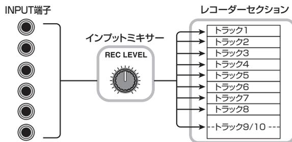
インプットミキサーでは、INPUT 1～6端子およびGUITAR/BASS INPUT 1～2端子から入力された信号の感度を調節し、パン、センドリターンエフェクトへの
