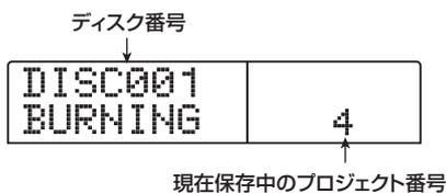
なお、バックアップが1枚のCD-R/RWディスクに収まりきれない場合は、容量を使い切った時点でCD-R/RWディスクが排出され、ディスプレイが次のように変わります。
