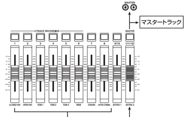
マスタートラックを録音状態にすると、[MASTER] フェーダー通過後の信号（OUTPUT端子から出力される信号と同じもの）が録音されます。
