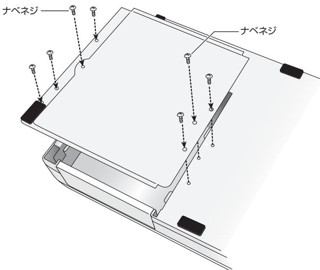
6. 底板を取り付けて、手順2で外したネジとドライブ固定用ナベネジ×2本を使ってドライブを固定してください。
