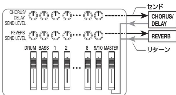
SENDリターンエフェクトのかかり具合は、トラックまたはドラム/ベース音色ごとのSENDレベル（各エフェクトに送られる信号のレベル）で調節します。SENDレベルを上げるほどエフェクトへ送られる信号のレベルが上がり、そのトラックまたはドラム/ベース音色のエフェクトのかかり具合が深くなります。ここではSENDリターンエフェクトのパッチを選び、トラックごとにSENDレベルを調節して、リバーブやコーラス/ディレイのかかり具合を調節します。
