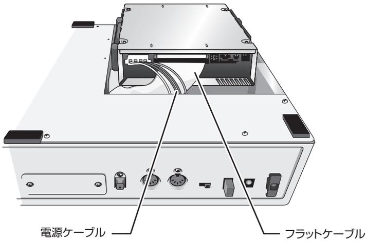
4. 本体から出ている電源ケーブルとフラットケーブルをCD-R/RWドライブに取り付けてください。
