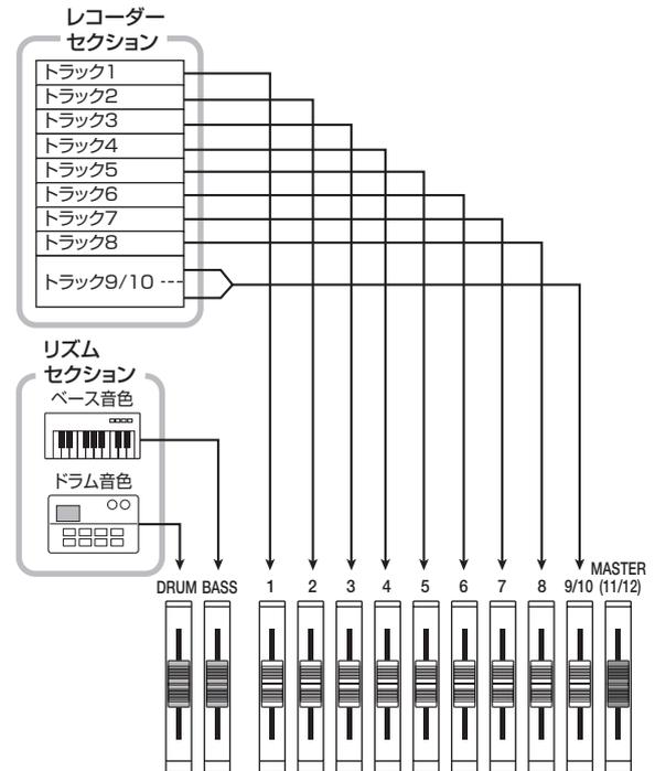
ディスプレイ下部のレベルメーターには、フェーダー通過後の各トラックやドラム／ベース音色の信号レベルが表示されます。また、レベルメーターの MASTER L/R には、[MASTER] フェーダー通過後の信号レベルが表示されます。音量を調節するときは、各レベルメーターの 0 (dB) のドットが点灯しないように注意しながら、ミックスを調節してください。
