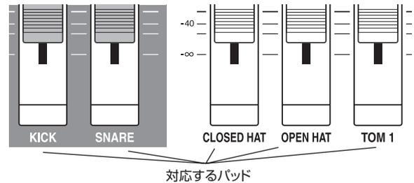
現在選ばれているパッド以外のフェーダーを操作すると、瞬時にそのパッドがエディット対象として選ばれ、同時にLEVELの設定値が変化します。
