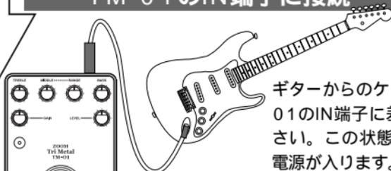
ギターからのケーブルをTM-01のIN端子に差し込んで下さい。この状態でTM-01の電源が入ります。
