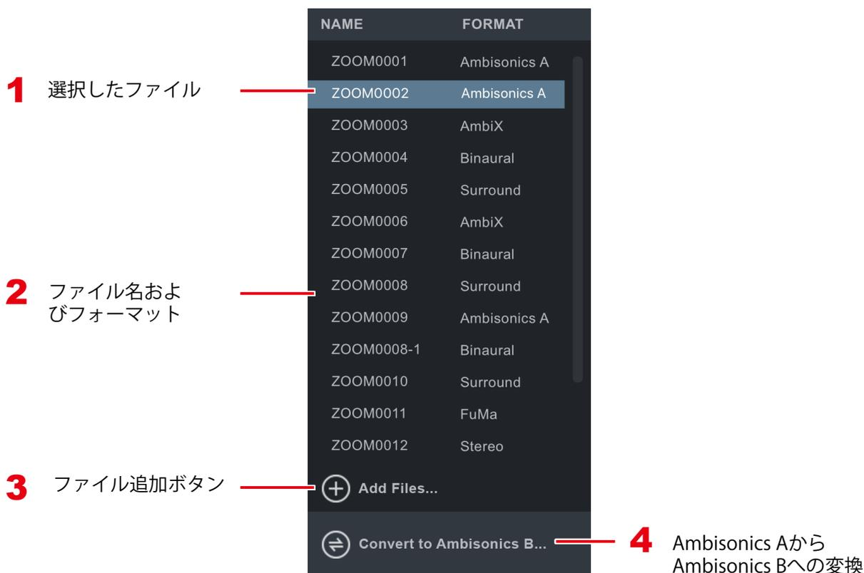
1. 選択したファイル - ファイルを選択すると、トランスポーズエリアとシークバーエリアがファイルの情報に合わせて変わります。一度に選択できるファイルは一つだけです。
