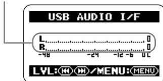
Medidores de nível
