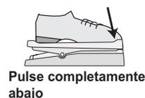
El pedal de expresión incorpora también un interruptor de pulsación que le permite el control on/off de un módulo de efectos concreto.
