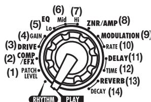
El módulo EQ tiene tres parámetros, mientras que los módulos MODULATION, DELAY y REVERB solo tienen dos.
