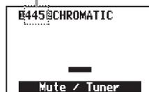
Puede ajustar el tono standard de La central en el rango 435–445 Hz.
