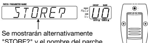
2. Utilice los interruptores de pedal BANK UP/DOWN y los interruptores de pedal 1 - 4 para seleccionar el destino de almacenamiento (copia).
