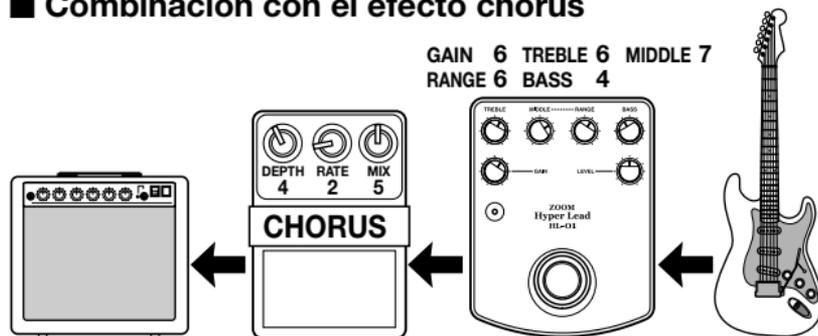
En este ejemplo, el chorus utiliza un ajuste de modulación (profundidad) ligera a una velocidad lenta (velocidad), para lograr un sonido ligero y airoso. Asegúrese de no ajustar la modulación chorus demasiado alta. Los solos de guitarra y los arpeggios al estilo de rock LA suenan muy bien con este ajuste.
