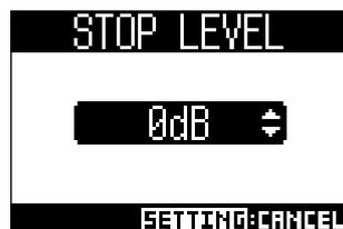
La grabación se detendrá automáticamente cuando el nivel de la señal emitida por el fader MASTER quede por debajo del umbral elegido durante el tiempo fijado en el paso 4.
