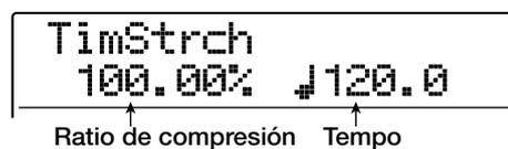
Esta pantalla le permite especificar el ratio para la expansión/compresión de tiempo de dos maneras diferentes :
