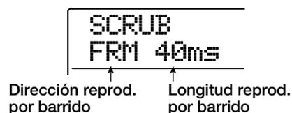
2. Si quiere modificar la longitud de la reproducción de barrido, utilice las teclas de cursor izquierdo/derecho para que la longitud de la reproducción de barrido empiece a parpadear y gire el dial.
