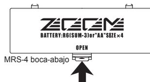
2. Introduzca cuatro pilas IEC R6 (tamaño AA) nuevas en el compartimento de las pilas. Recomendamos que use pilas alcalinas.
