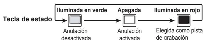
Cuando la tecla de estado 1 cambia de verde a rojo, la pista 1 queda en la condición de espera de grabación. El direccionamiento de la señal de entrada en ese caso es el siguiente
