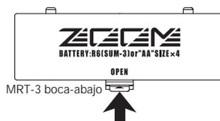
2. Introduzca cuatro pilas nuevas IEC R6 (tamaño AA). Le recomendamos que utilice pilas alcalinas.
