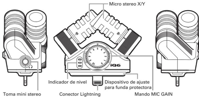
**Micro stereo X/Y:** Este es un micrófono stereo de formato X/Y. Puede ajustar el ángulo de grabación a 90° o 120° girando los micros individuales. (Vea "Ajuste de la amplitud stereo").
